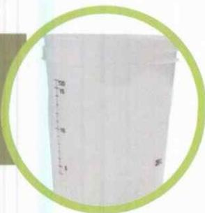
Para seguir con el proceso de calibración hay que colocar la succión en un balde o caneca con un volumen de agua conocido, ejemplo 20 lt.
