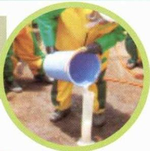
Sacar el líquido de la bolsa y escurrirlo en una probeta o recipiente que este aforado
